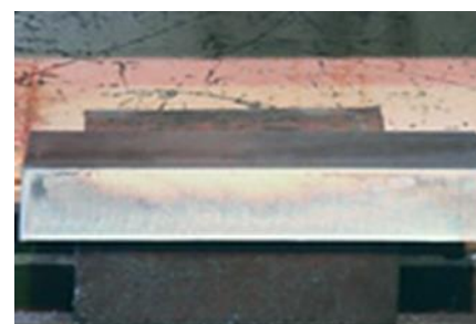
ハイドロカット切断面 (粗さ: Ra6.845 μm Rz38.340 μm)
