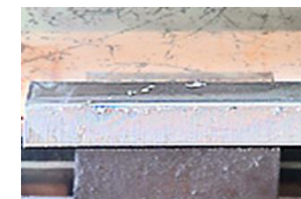
アセチレン切断面 (粗さ: Ra6.992 μm Rz41.014 μm)
