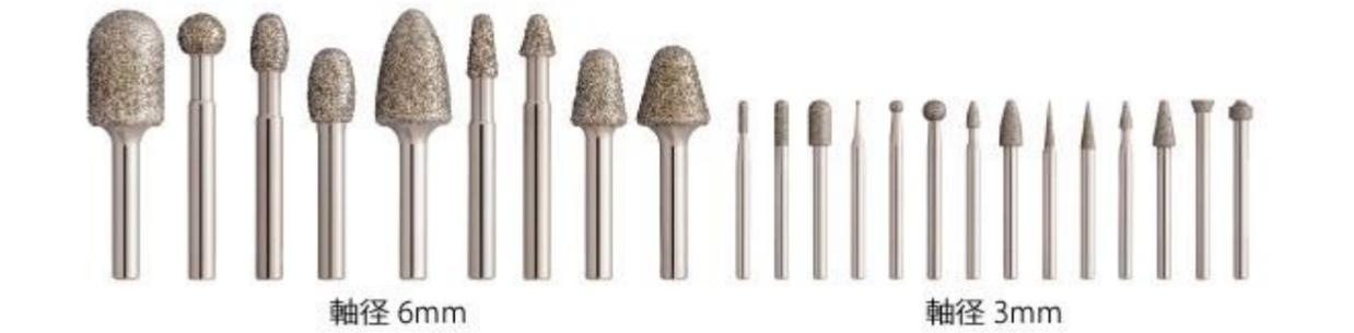
結晶性が高く脱粒しにくい合成ダイヤモンドを使用しているため、耐久性に優れています。砂噛みも一発除去できる研削力があります。一般砥粒（アルミナ）と比べ約3倍程硬いダイヤモンドが、脱粒せず絶えず表面に出ているので、鑄物砂が溶け込んだ「砂噛み」「焼付き」も驚くほど容易に研削が可能です。従来の砥石のように力を入れて作業する必要がないため、疲労感も少なく作業性がアップします。極めて硬い物質であるダイヤモンドを独自の電着技術で強固に固定しているため、従来の軸付砥石と比較して圧倒的な耐久性を実現しています。変形摩耗せず、刃こぼれしません。形状が変わらないため、隅のR部も綺麗に研削できます。
