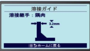
継手と板厚を選択するだけで溶接条件を自動で設定\*。溶接作業が不慣れな方の条件出しをサポートします。
