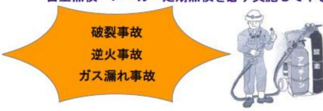
\*注1:可燃性ガス及び酸素を用いて行う金属の溶接、溶断又は加熱の業務を行う場合は、ガス溶接技能購習終了者あるいは ガス溶接作業主任者の免許を有していることが必要です。(労働安全衛生法第61条、及び執行令第20条)
